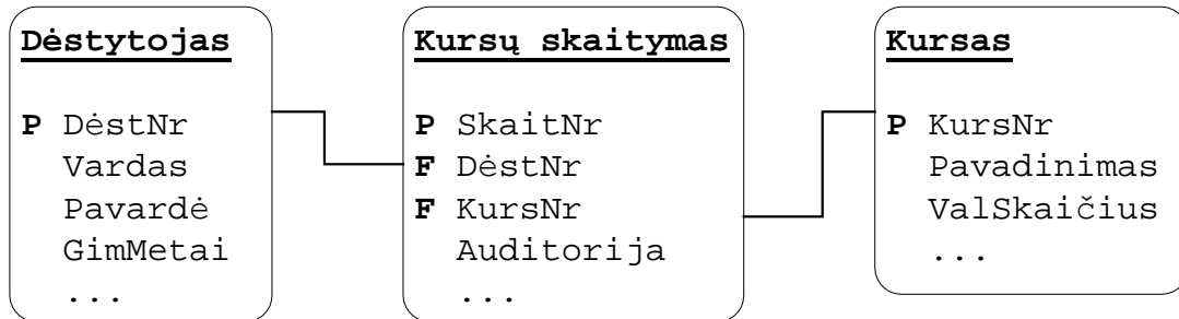
16 pav. "Tiesmukiškas" 1:N ryšio realizavimas
